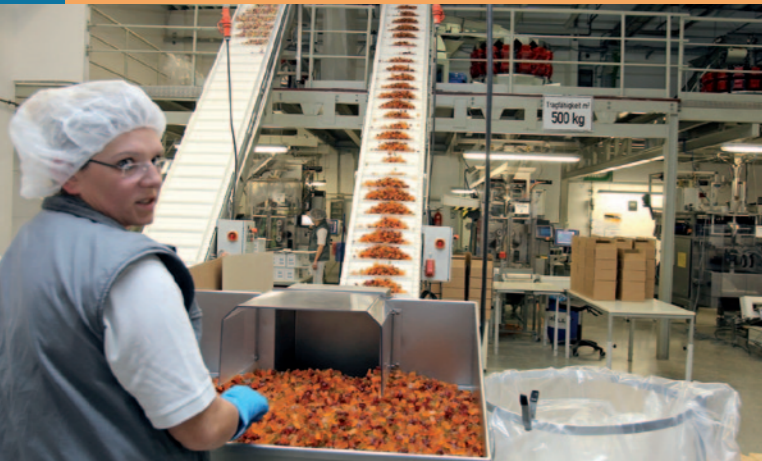
Die Gummibärchen werden über Förderband zum Abwiegen und Verpacken transportiert.
